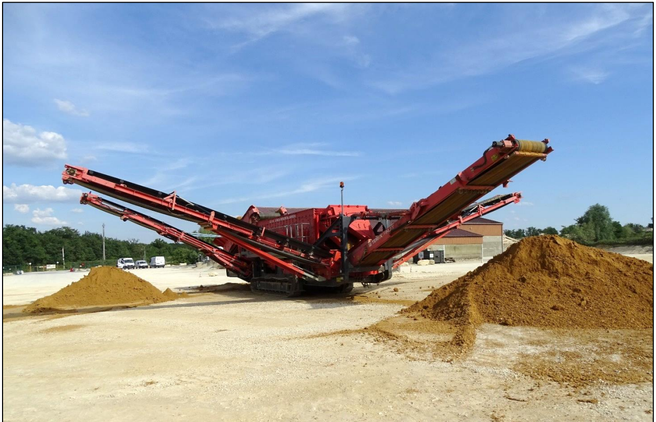
Figure 15 : Crible mobile pour le « sable à lapin » en provenance de la carrière « Les Veaux », LAVAUX (juin 2020)
